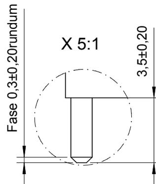
Oberfläche 5-10µm Sn über 2-4µm Cu®
